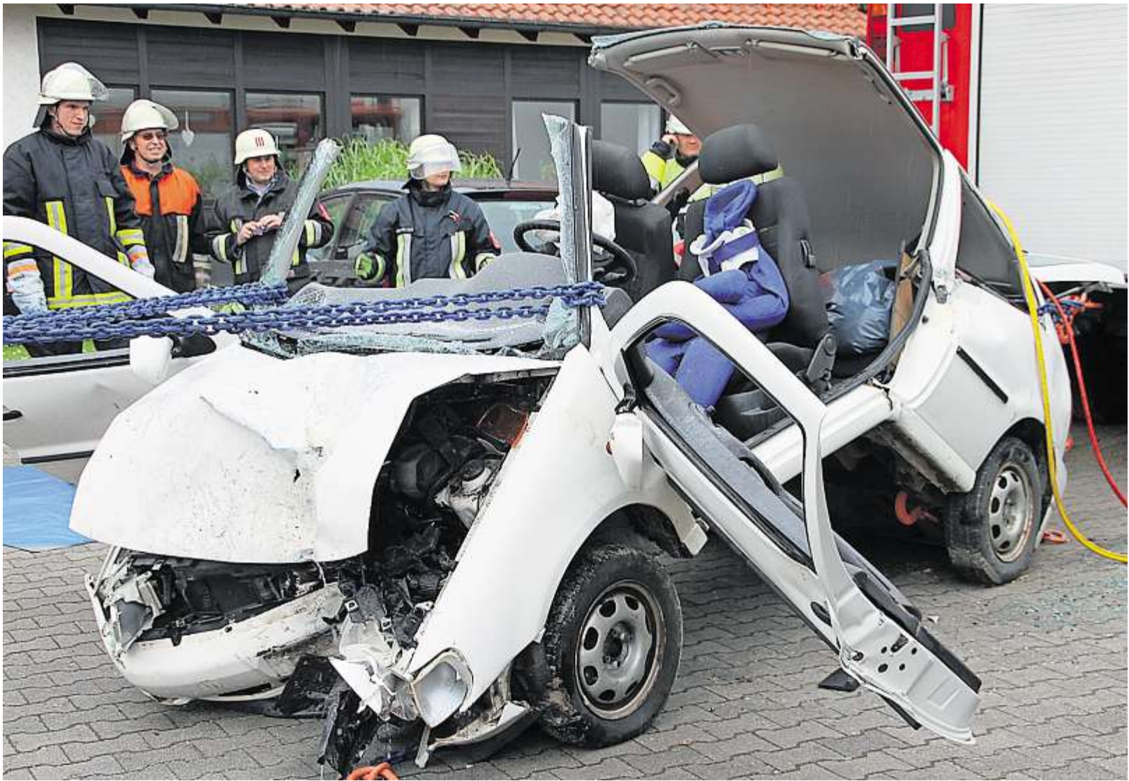
Das mit Kettenzug geöffnete Versuchsauto: Links im Bild sind die an den A-Säulen angeschlagenen Ketten zu sehen. Der Knick im Schweller an der B-Säule entstand durch das Auseinanderziehen ohne Entlastungsschnitte. Fotos: Felix Bonn
